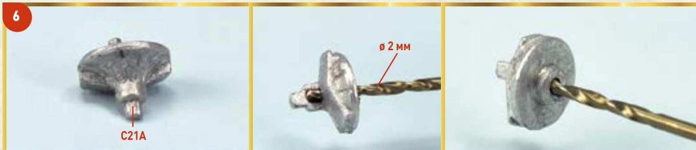
**6** Теперь возьмите деталь C21A и дрелью со сверлом диаметром 2 мм проделайте в ней сквозное отверстие так, как показано на фотографиях.
