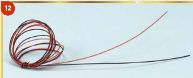
**12** Возьмите два разноцветных провода для светодиодной подсветки длиной примерно 400 мм каждый. Проведите эти провода в отверстие, изготовленное в шаге 11, после чего вставьте их в трубку, вклеенную в декоративную деталь С21А. Приклейте деталь С21А по центру гакаборта так, как показано на фотографии. Обратите внимание на то, что трубка должна располагаться вертикально.
